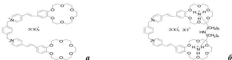
Рис. 1. Структура ОМС-5 (а) и схема образования комплекса состава 1:1 (б) между ОМС-5 и спермидином
